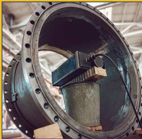
↑ Equipo de rayos X utilizado para inspeccionar las soldaduras de un elemento de intercambio de calor.
