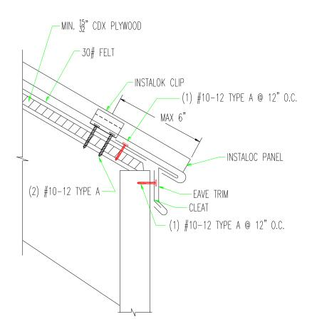
NOTE: NOTCH SEAM BACK 7/8" AND FOLD PAN AROUND EXTENDED EAVE.
