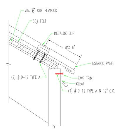
NOTE: NOTCH SEAM BACK 7/8" AND FOLD PAN AROUND EXTENDED EAVE.
