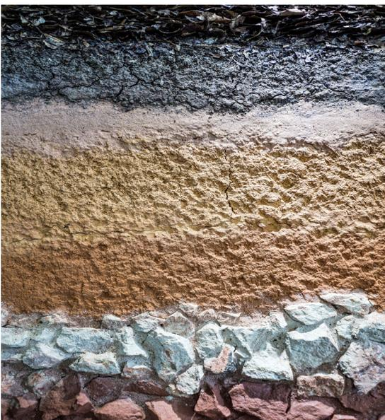
Las fuerzas horizontales y verticales dentro de la tierra mantienen el suelo intacto en su lugar. Una excavación perturba o elimina estas fuerzas. El suelo se mueve naturalmente hacia abajo y hacia adentro a causa de una variedad de factores, tales como el tipo de suelo, la humedad, la vibración y el peso de la carga que hay encima.
