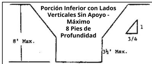
Todas las excavaciones de más de 8 pies pero no más de 12 pies de profundidad con porciones inferiores con lados verticales sin apoyo deberán tener una pendiente máxima permitida de 1:1 y un lado vertical máximo de 3½ pies.
