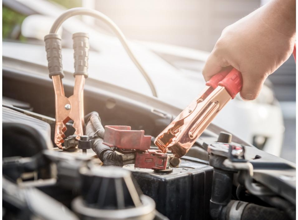
sostenida durante largos períodos de tiempo.<sup>2</sup> Estas baterías contienen un líquido (un electrolito) hecho de ácido sulfúrico y agua. La combinación del electrolito con las placas de plomo dentro de la batería puede producir gases altamente combustibles que deben ventilarse.
