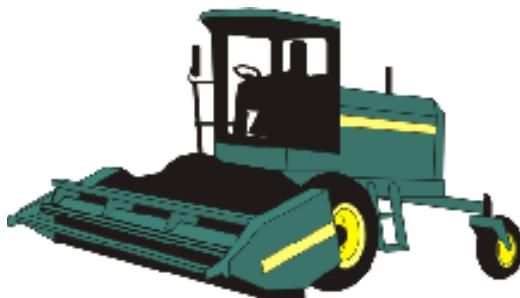
Un ROPS proporciona mejor protección al operador en caso de una volcadura. Un ROPS está diseñado con fin de limitar la volcadura a los 90°, lo cual reduce muertos.
